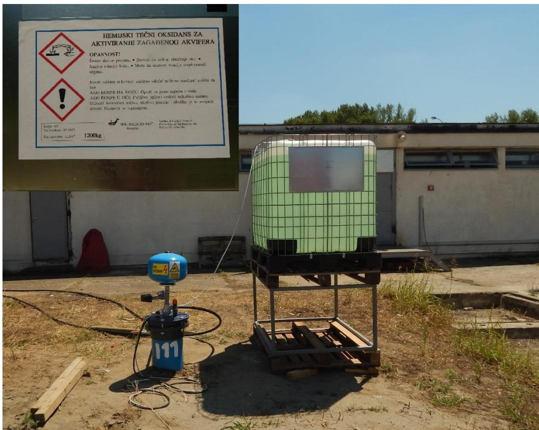
**Slika 4.6.** Prikaz operativnog IEB-a i aktivacije akvifera pomoću 30% w/v H<sub>2</sub>O<sub>2</sub>
