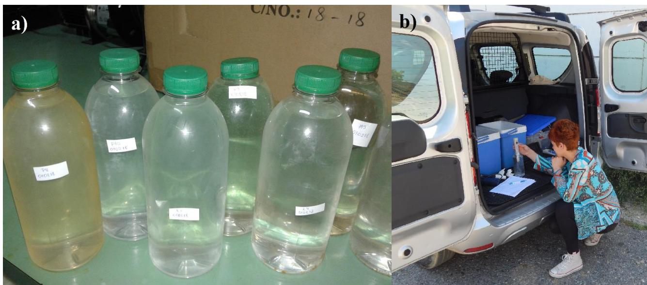
**Slika 3.2.** Uzorci podzemnih voda po prijemu u laboratoriju (a) i terensko merenje fizičko-hemijskih parametara (b)
