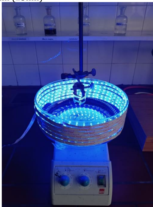
Slika 11. Aparatura za fotohemijske reakcije.
