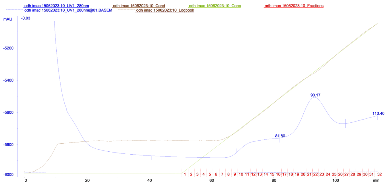
Slika 7. Hromatogram prečišćavanja opin dehidrogenaze afinitetnom hromatografijom na Ni-NTA koloni.
