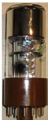
Слика 7: Фотомултипликатор (лево) и његов попречни пресек (десно).
