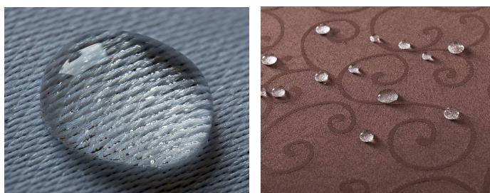
Slika 7. Kap vode na nekvašljivoj, vodoodbojnoj tkanini (damastu). Površinski napon je dovoljno veliki da spreči kvašenje i prodor vode ispod tkanine.
