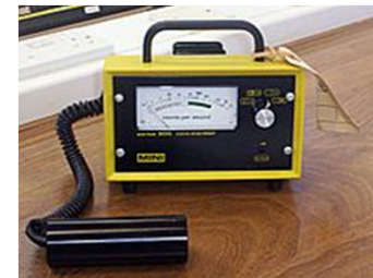
Gajger-Milerov brojač (detektuje alfa, beta i gama zračenje na bazi efekta jonizacije)
