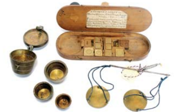
Ручна фармацевтска вага са теговима са сетом припадајућих тегова у систему бечких апотекарских мера и комплет од 5 тегова у облику посуда An old manual pharmaceutical weighing scales with the Viennese standard of weights and a set of 5 weights in the shape of dishes
