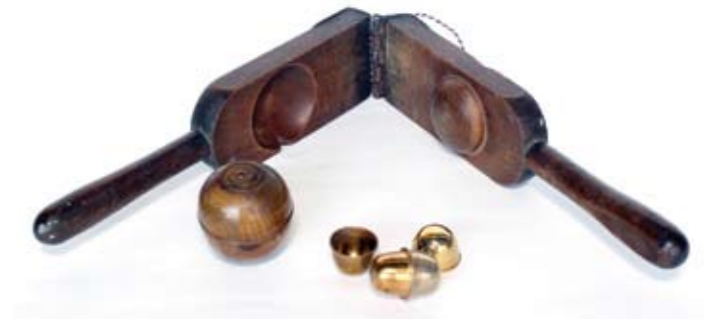
Ручна преса за трохисце и прибор за израду пилула A manual press for trochiscs and accessories for making pills
