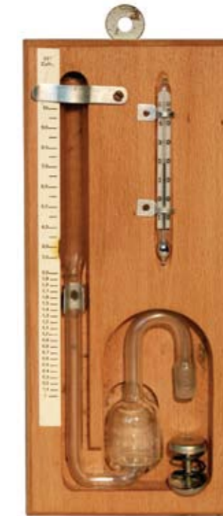
Лабораторијски барометар са термометром A laboratory barometer with thermometer
